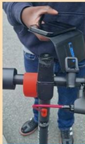
Trimmer / endrer hastighetssperren
